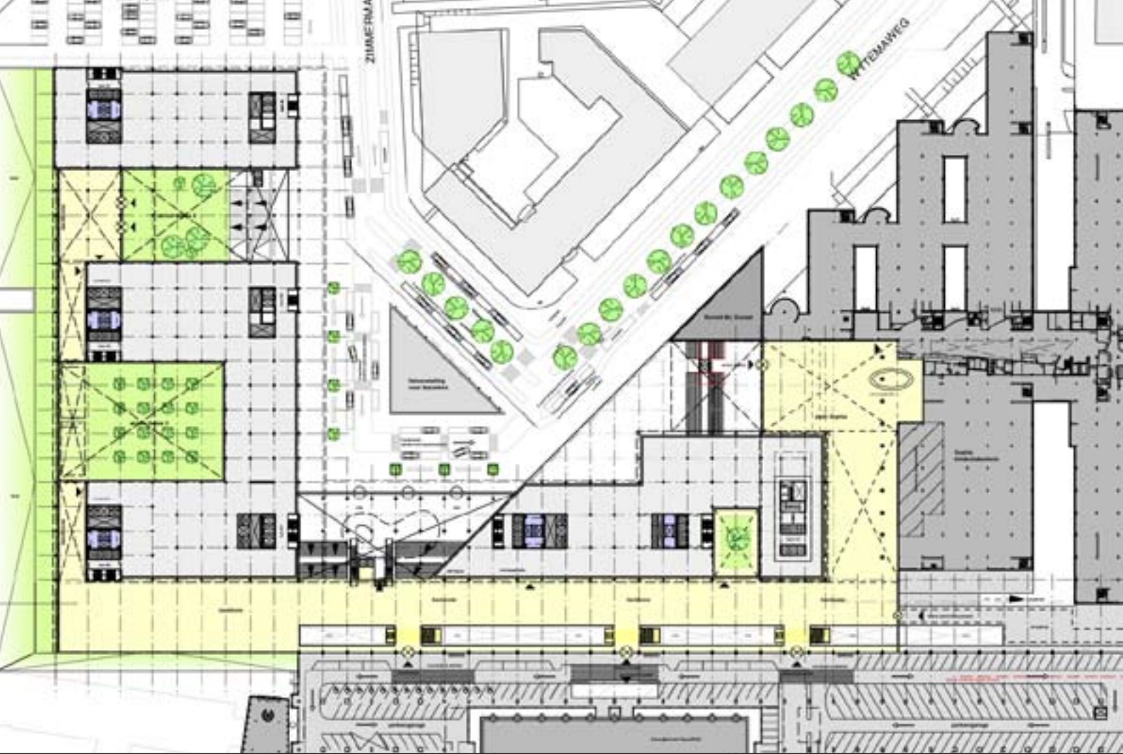
Backbone en technische lokalen op maaiveldniveau
